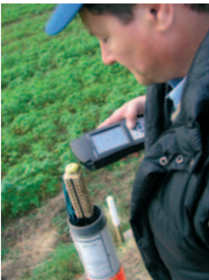
Positie-identificatie van KKS meetpalen via het unieke ID-Nr. van de RFID transponder
